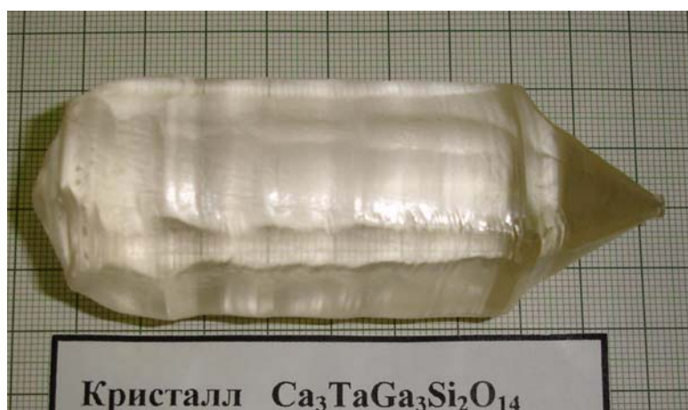
Рис. 1.3.4. Кристалл КГТС, выращенный вдоль кристаллографической оси [11.0]
