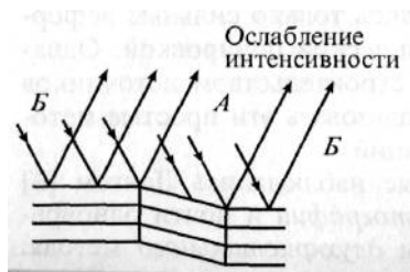
Рис. 1.4.5. Ориентационный контраст в условиях монохроматизированного коллимированного рентгеновского пучка. Дифракция в области A имеет место только для конкретного углового положения образца.
