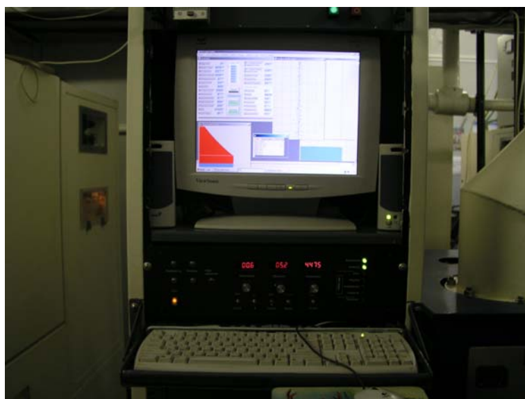
Рис. 1.3.2. Модернизированная система управления установки выращивания кристаллов.
