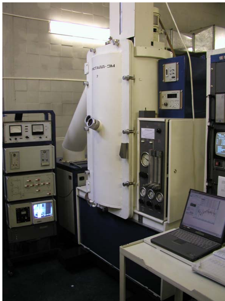
Рис. 1.3.1. Внешний вид установки выращивания кристаллов «Кристалл-3м»
