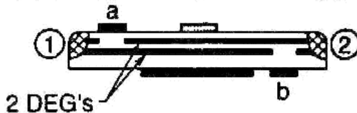
Рис. 1. Схематическое изображение образца для исследования 2D-2D туннелирования с вертикальным и горизонтальным транспортом.
