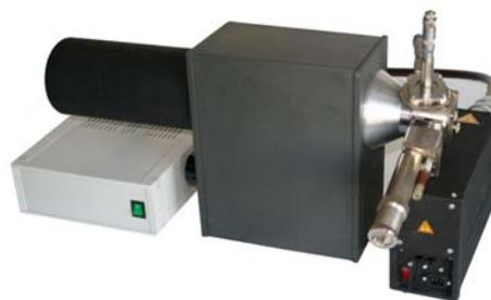
Рис. 2. Вариант конструкции рентгеновского источника с камерой от микроскопа МРЭМ-200.
