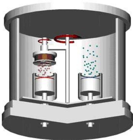
Рис.1. Схема процесса коррекции оптической подложки методом вакуумного нанесения тонких пленок через маску.
