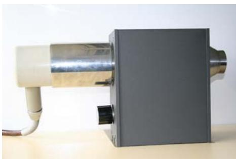
Рис. 1 Разборная рентгеновская трубка
