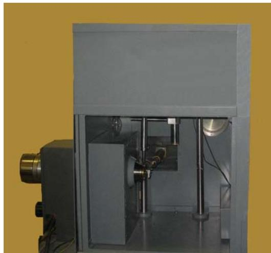
Рис. 8. Просвечивающий рентгеновский микроскоп (ПРМ) с разборной трубкой на левой стенке защитной камеры и столиком объектов на задней стенке.
