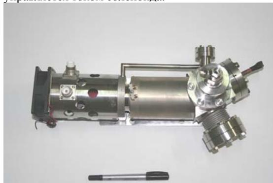
Рис.5. Фотография трубки с изменяемым размером пятна.
