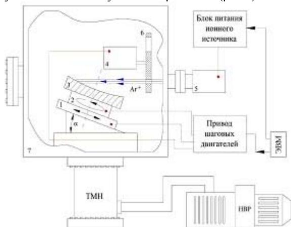
Рис.2. Схема установки ионного травления. 1 – линейное перемещение образца; 2 – вращение образца; 3 – образец (оптическая подложка); 4 – шаговый двигатель привода диафрагм; 5 – ионный источник; 6 – диск со сменными диафрагмами (в одной из позиций установлен измеритель ионного тока); 7 – вакуумная камера.
