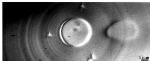
Рис. 2. Топограмма кристалла LGT, выращенного вдоль оси роста  $\{001\}$ . Отражение (002),  $\Theta_B = 17.495^\circ$ .
