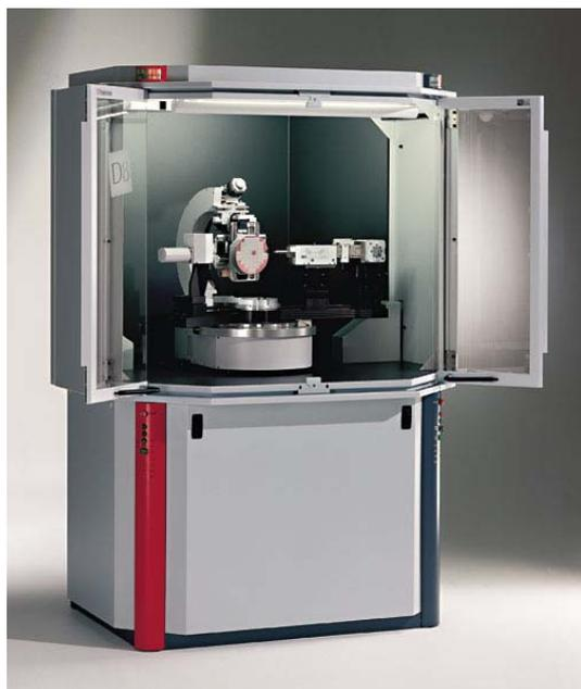
Рис. 4. Рентгеновский дифрактометр D8 "DISCOVER"
